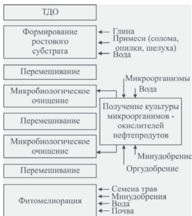
Рис. Последовательность технологических операций обезвреживания ТДО
